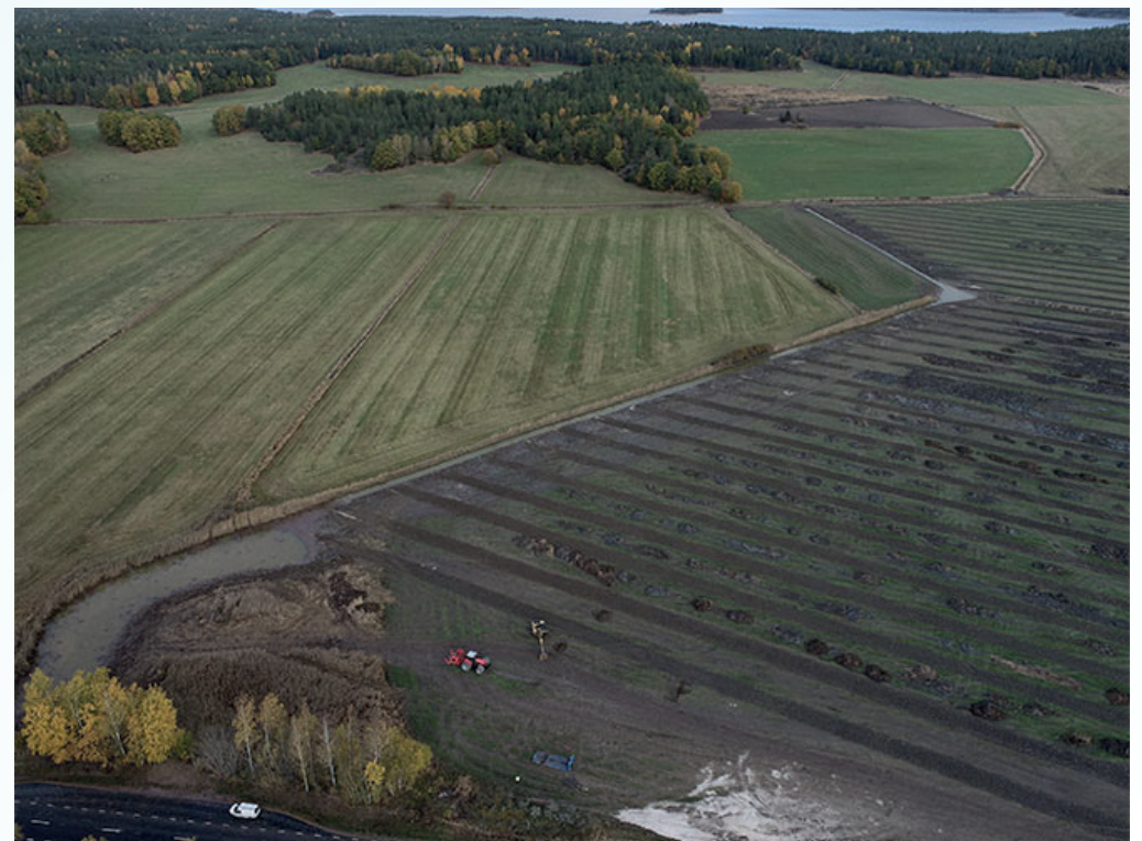
Strukturkalkning, filtergrøfter og fosfordam
