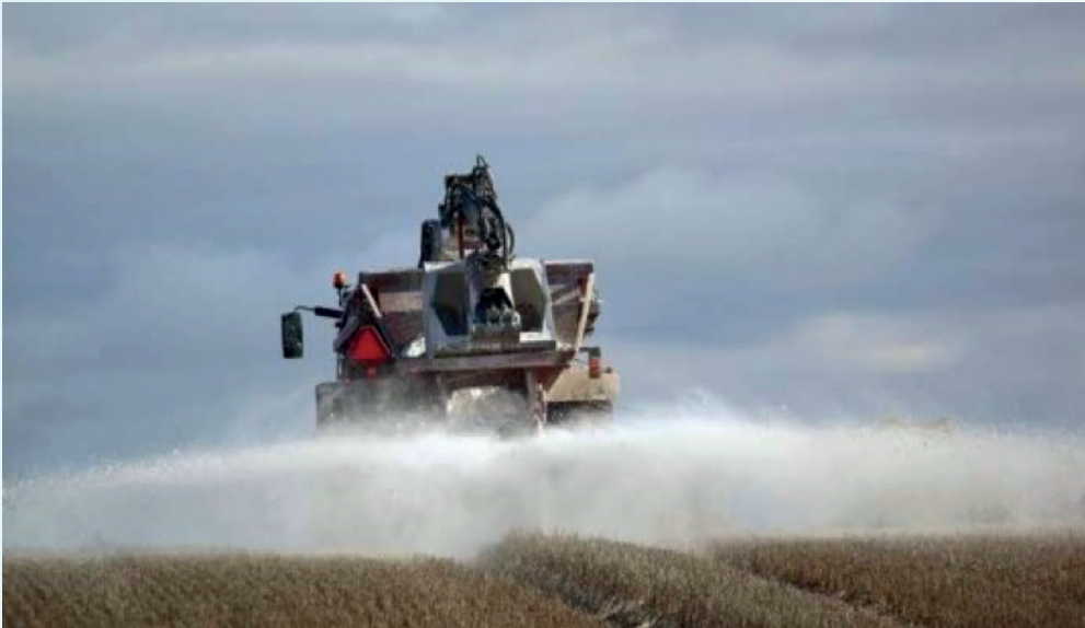
Kalk- eller gødningsspreder kan bruges til at sprede gips. (Foto: Pasi Valkama)
