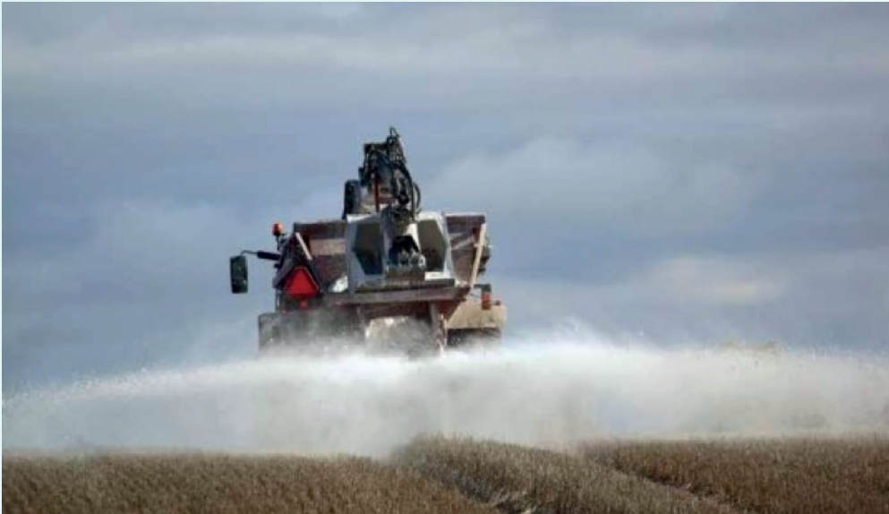
Laotamiseks võib kasutada lubja- või sõnnikulaoturit kips. (Foto: Pasi Valkama)
