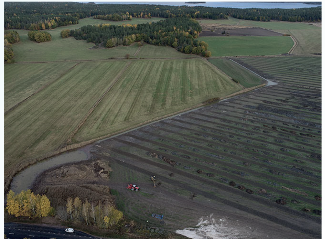
Struktury wapienne, rowy filtracyjne i staw fosforowy
