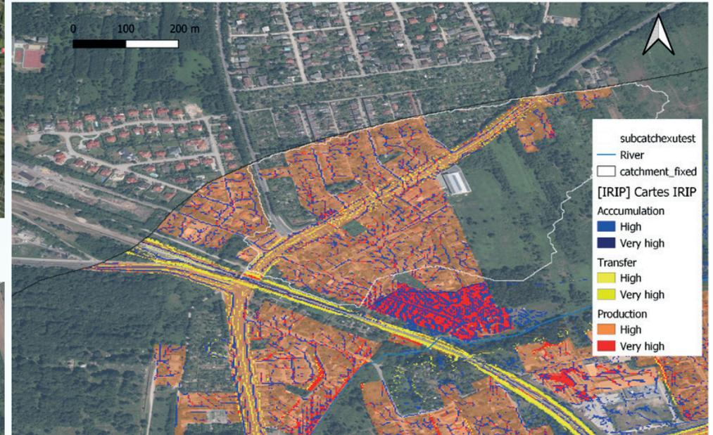
Produktionsbereiche mit intensivem Abfluss
