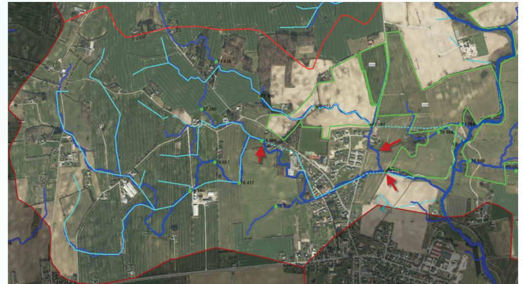
Entwässerung und Einzugsgebiet durch Feldbesuche durchgeführt
